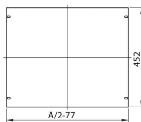
PLYTA MONTAŻOWA NADSTAWKI UKŁADU POMIAROWEGO
